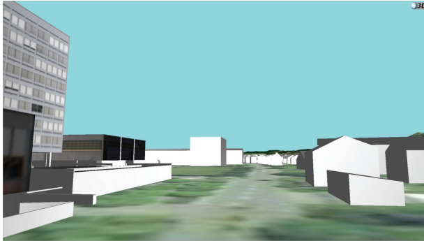
Abb. 7: Geometrische 3D-Modellierung des FHNW-Campus mit ausgewählten texturierten 3D-Objekten integriert in virtuellen Globus i3D
